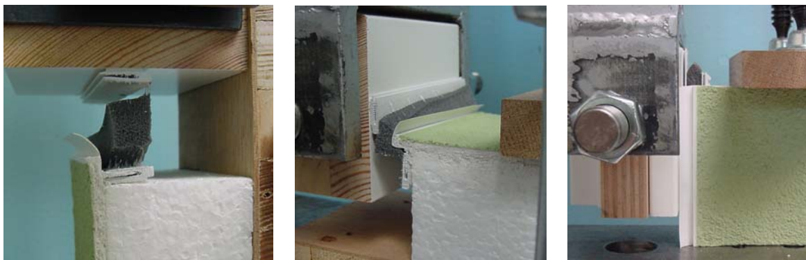
Bilder 8 bis 10 Versagensarten bei Dehnung, Scherung quer und Scherung längs
